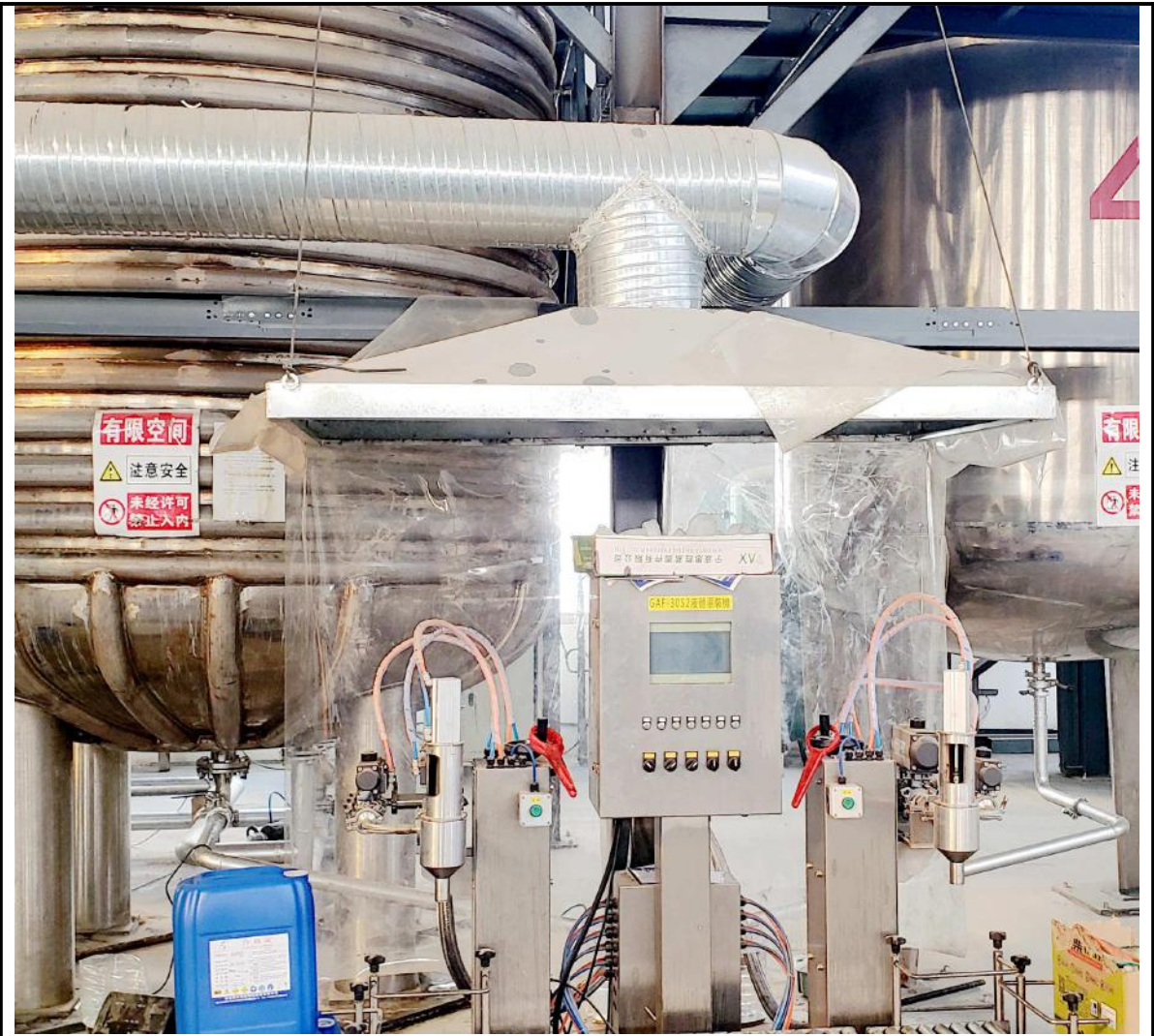
图 3-1 灌装设备集气罩
