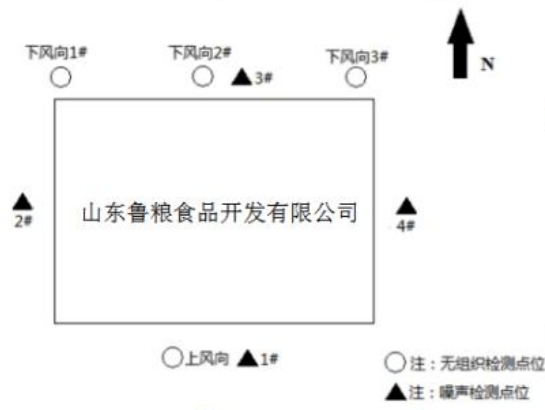
图 6-1 噪声、无组织废气监测布点示意图
