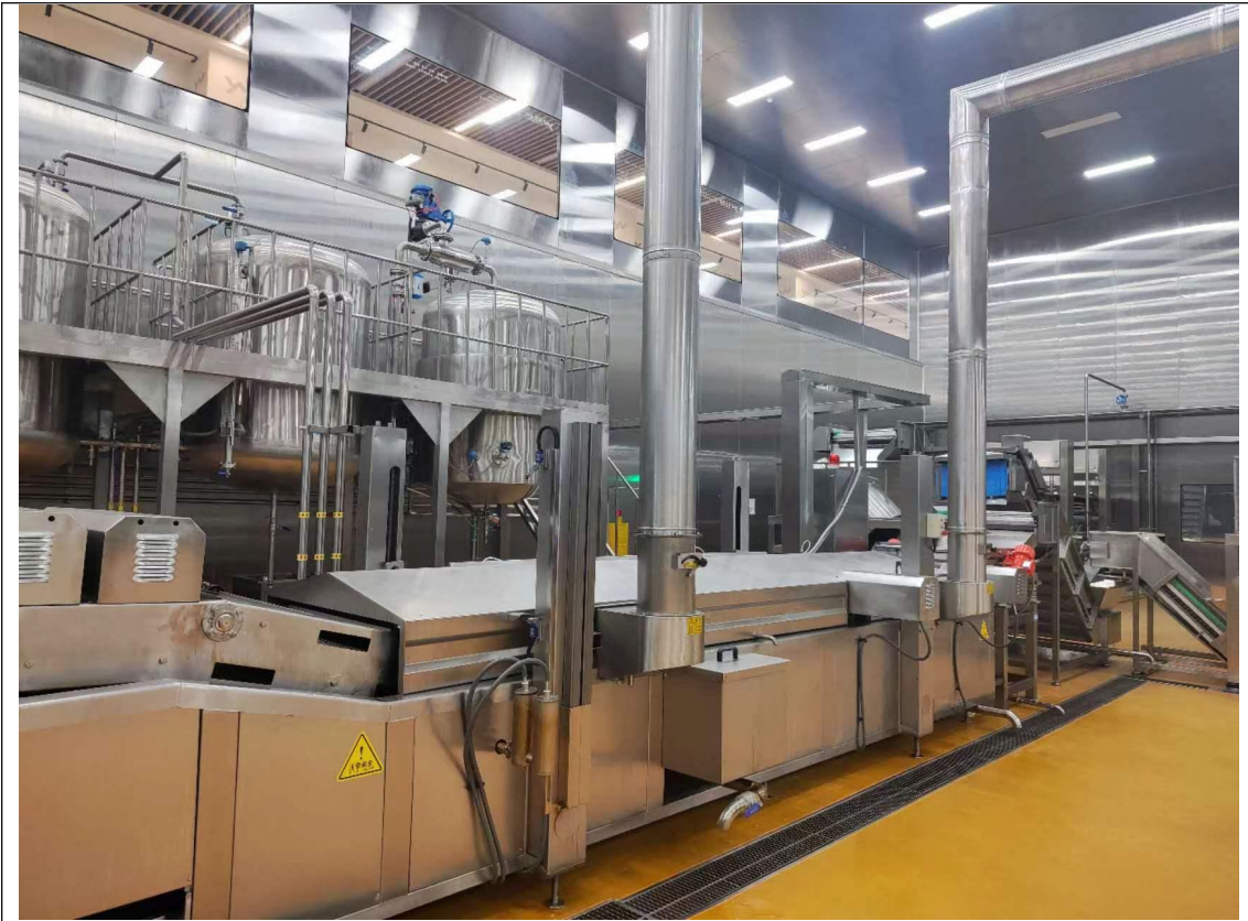
图 3-4 油炸线密闭和油炸废气收集管道
