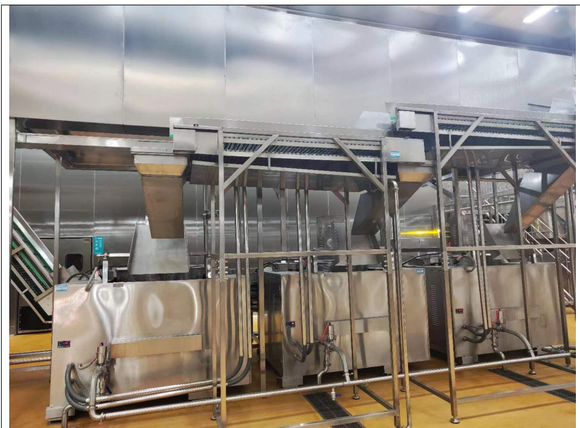
图 3-2 炒卤制工序集气罩
