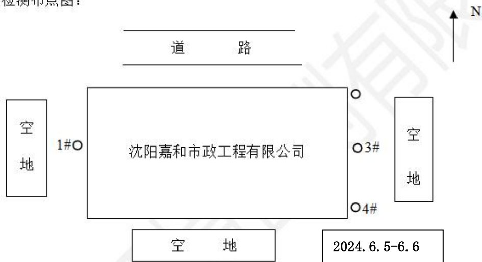
图 6-1 无组织废气监测布点示意图
